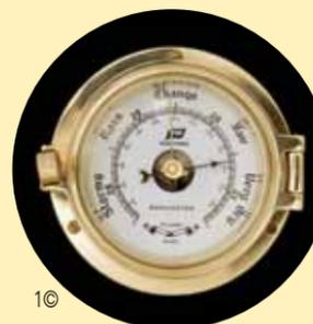
**Barômetro** – é usado para medir a pressão atmosférica. Ele pode ser do tipo coluna de mercúrio ou do tipo aneróide (metálico). O ar aplica uma pressão com seu peso. Quanto maior a pressão do ar, mais comprida fica a coluna de mercúrio. Assim, a pressão pode ser calculada, multiplicando-se o peso da coluna de mercúrio pela densidade do mercúrio e pela aceleração da gravidade.
